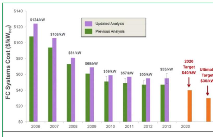
Fig. 2 – Evoluzione del costo delle pile a combustibile per i trasporti, assumendo una produzione di 500 mila unità l'anno. Fonte: U.S. Department of Energy, *2013 Fuel Cell Technologies Market Report*.
