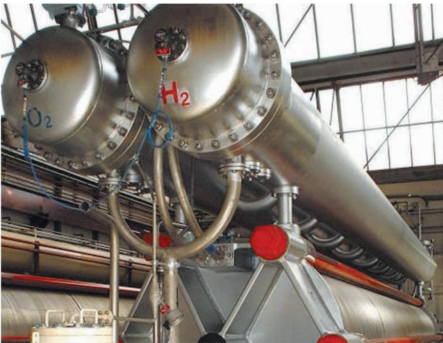
Energia verde Sopra un elettrolizzatore necessario alla produzione di idrogeno
